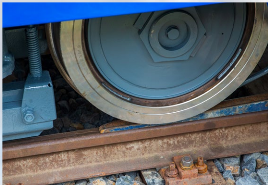
Původní tramvajové obruče dvojkolí byly nahrazeny železničními
